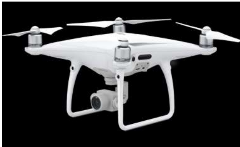
รูปภาพที่ 2 : แสดง อากาศยานไร้คนขับ ชนิด ปีกหมุน (Multi-Rotor) DJI Phantom 4 Pro
