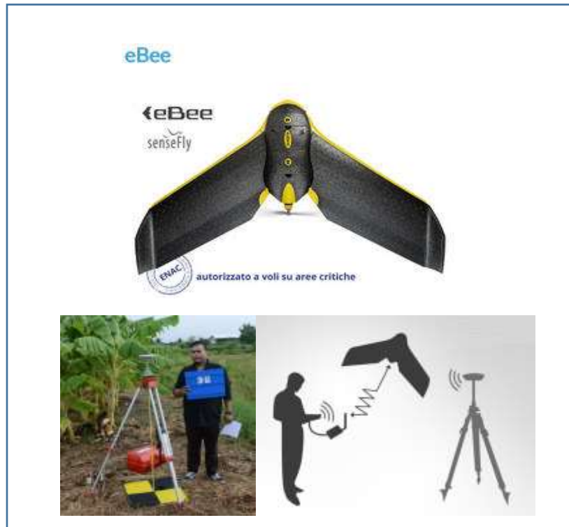
รูปภาพที่ 3 : แสดงอากาศยานไร้คนบิน ชนิด ปีกตรึง (Fixed wing) EBEE
