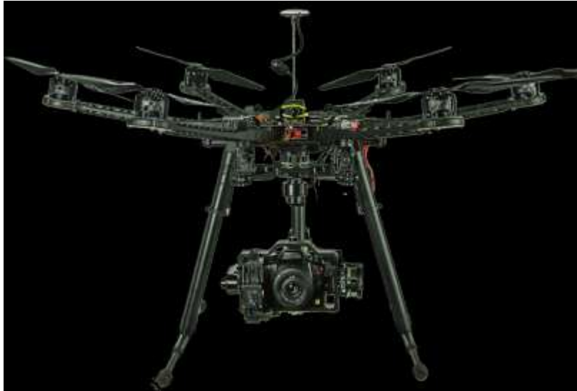
รูปภาพที่ 1 : แสดง อากาศยานไร้คนขับ ชนิด ปีกหมุน (Multi-Rotor) DJI S1000
